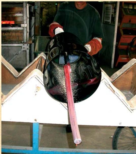
Deux étapes du procédé du manchon tel qu'il est encore mis en œuvre à la verrerie de Saint-Just (Loire) : l'application d'un choc thermique pour fendre le cylindre et mise à plat dans l'étenderie à l'aide d'une palette de bouleau détrempée d'eau.
