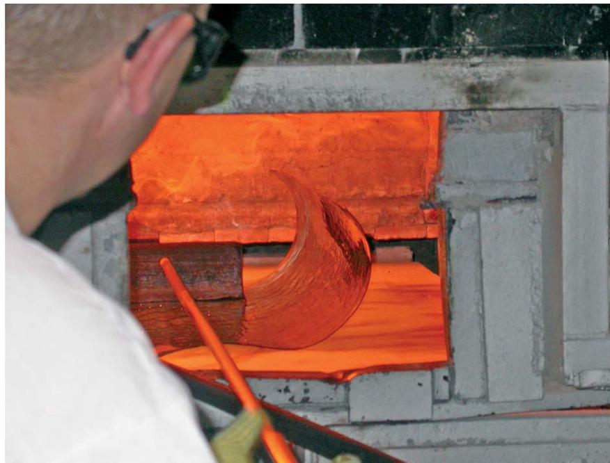
Fig. 1. Production de verre plat par l'ancienne méthode du manchon. Après avoir été fendu dans sa longueur, le manchon est mis à plat dans une étenderie à une température telle que la viscosité est de l'ordre de  $10^6$  Pa.s (cliché pris à la verrerie de St-Just, groupe St-Gobain). Traditionnellement, le manchon était obtenu par décalottage à froid des deux extrémités d'une longue pièce obtenue par soufflage.
