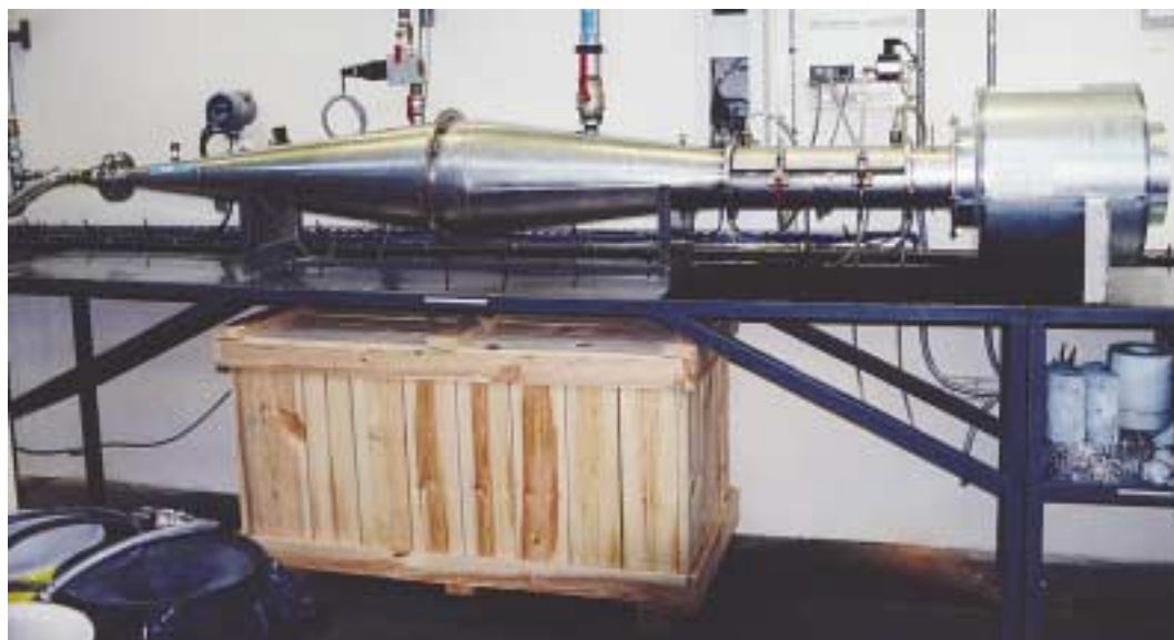
Banc d'essai pour mesurer la perte de charge à travers les filtres à particules en carbure de silicium (échappements des moteurs diesel)
