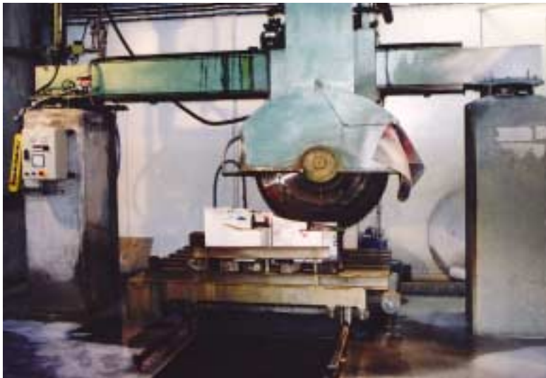
Scie diamantée pour découpe d'échantillons réfractaires
