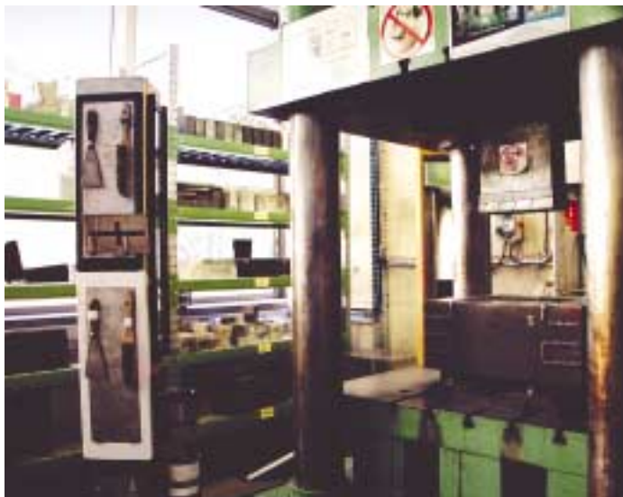
A droite : presse unidirectionnelle 300 tonnes. A noter les efforts de rangement des outillages dans le cadre des politiques 5S et sécurité du site
