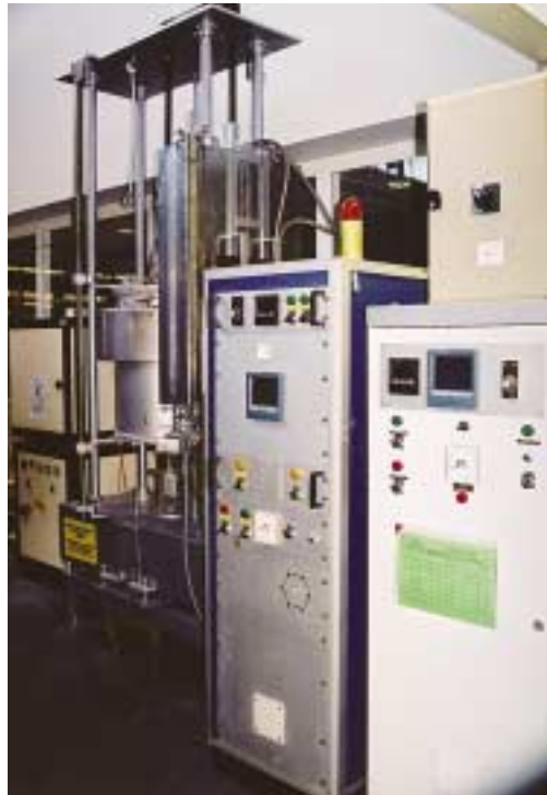
Four de fluage en compression à haute température permettant de simuler le fluage des voûtes des fours de verrerie
