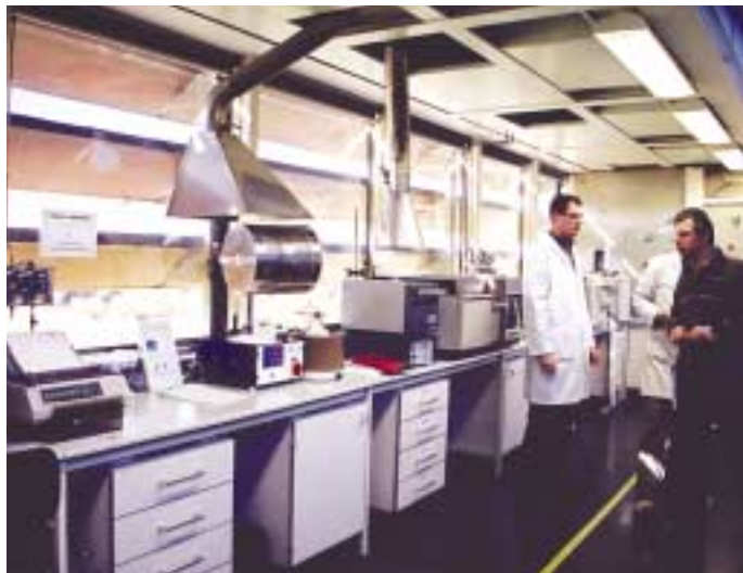
Laboratoire d'analyses chimiques : analyseurs azote/oxygène, four de pyrohydrolyse et chromatographe en phase gazeuse (CPG)
