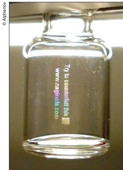
◀ Figure 6 : marquage intra-volume anti-contrefaçon
