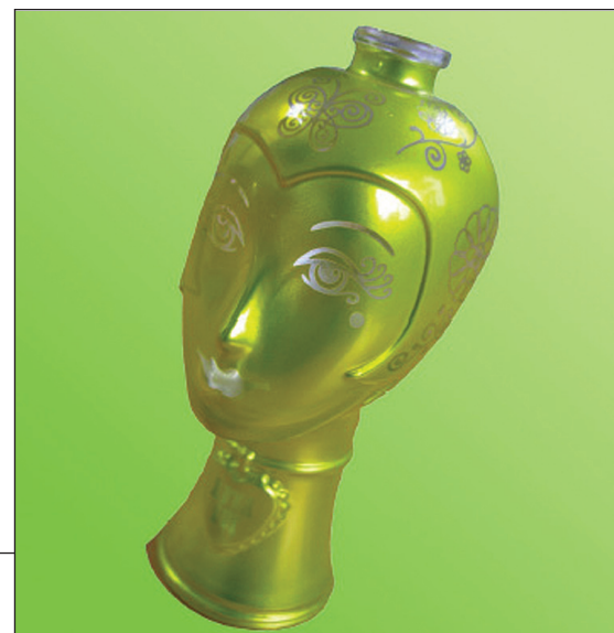
Figure 3 : ablation laser sur flacon de parfumerie
