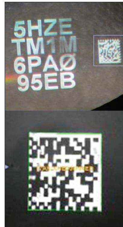
Figure 7 : marquage intra-volume anti-contrefaçon ▶
