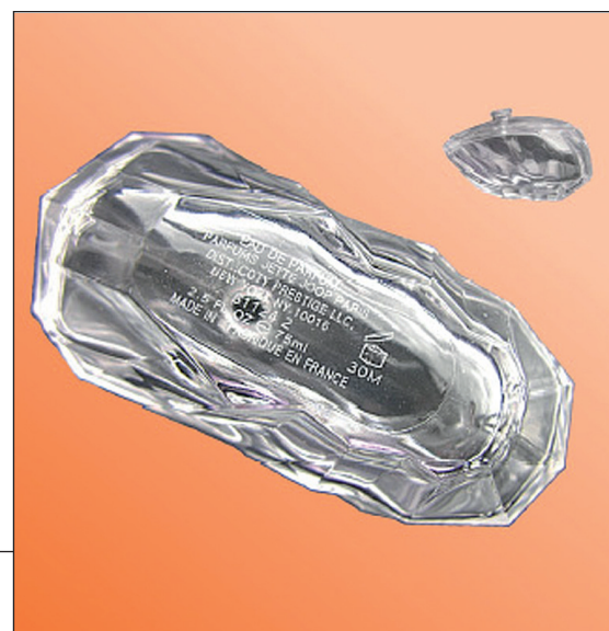
Figure 2 : marquage laser sur flacon de parfumerie
