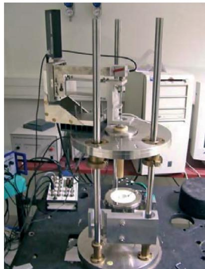
Ce dispositif permet de travailler sur de très petits échantillons de quelques  $\text{mm}^3$  et ne nécessite pas de mise en forme particulière, souvent si délicate voire rédhibitoire pour les matériaux fragiles. L'appareil d'indentation à chaud permet également d'effectuer des essais à pénétration ou à vitesse de pénétration imposée et d'accéder à la fonction de relaxation ou encore à la charge critique d'endommagement en fonction de la température.
