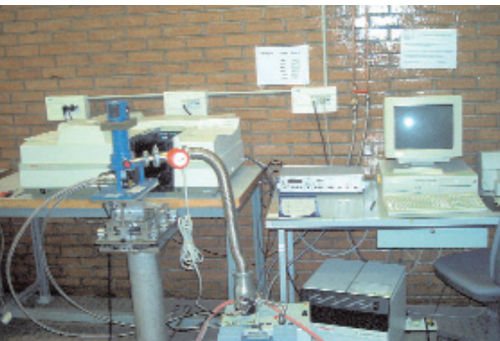
Spectromètre UV-visible-proche infrarouge avec un cryostat permettant des acquisitions de spectres jusqu'à 10 K
