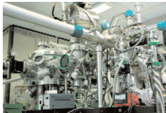
Figure 1. Bâti MISSTIC de dépôt par pulvérisation cathodique d'empilements de couches minces
