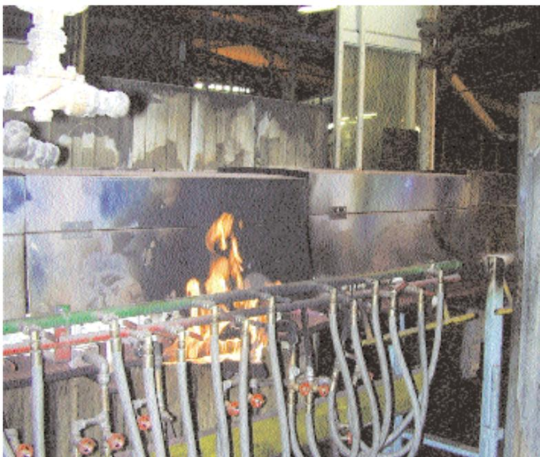
Utilisation de brûleurs air-gaz pour le réchauffage de tapis transfert métalliques
